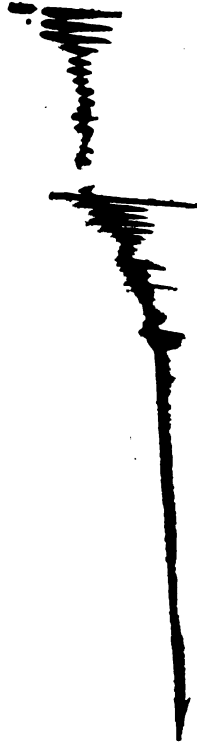
Fig. 9. — Même expérience que dans la figure précédente, mais avec un tube de 10 mm. La flamme s'éteint avant d'avoir parcouru le premier tronçon de 1. m.
